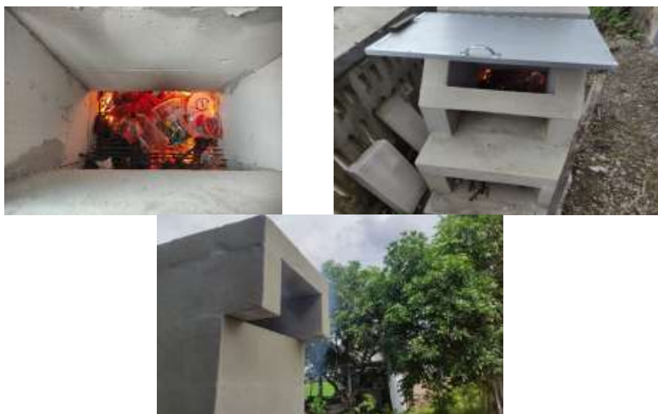
Gambar 5 Proses Uji Coba Tungku Pembakaran Sampah Minim Asap
